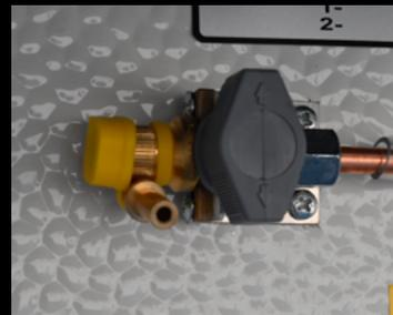
DER Gasanschluss im Kofferraum sorgt dafür, dass Sie keine Gasflaschen für den Grill mehr einpacken müssen – Sie schließen einfach Ihren Grill an den Gasanschluss des Wohnwagens an.
